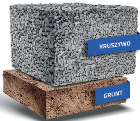
— Przekrój bez geokomórki
